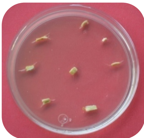
Fig. 2. Trozos de tallo y raíz de tomatillo con síntomas de pudrición sembrados en cajas Petri con medio PDA para llevar a cabo el aislamiento de hongos.
